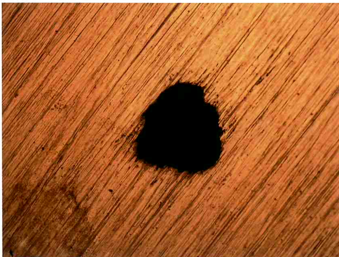
Figura 37: Pite formado na região do cordão de solda. Aumento 200X
