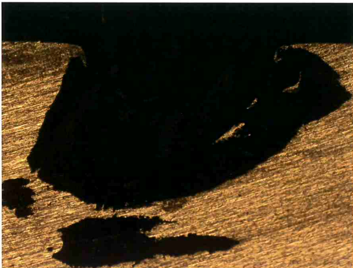
Figura 28: Sessão transversal do pite formado no ensaio de imersão em cloreto férrico
