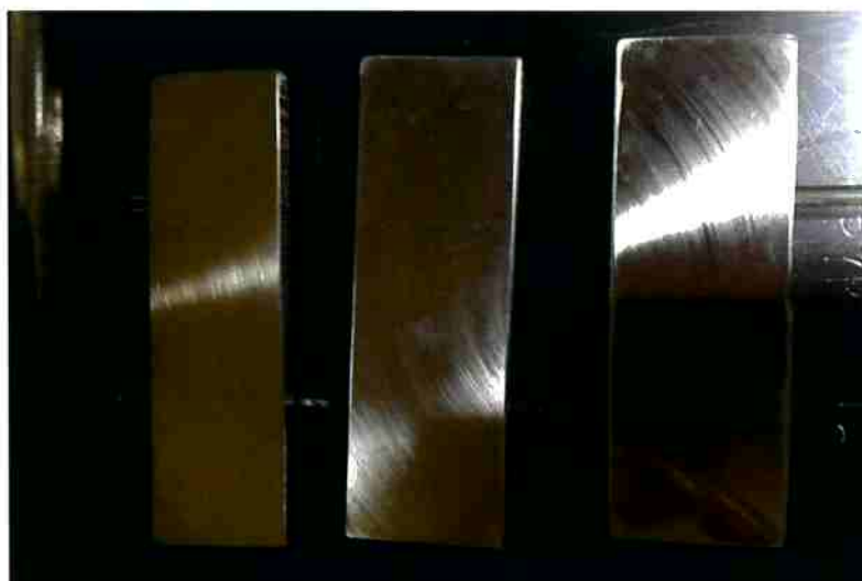
Figura 14: Posicionamento dos corpos de prova para ensaio de imersão antes da imersão em solução de cloreto férrico
