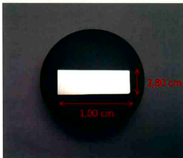
Figura 18: Corpo de prova para ataque metalográfico
