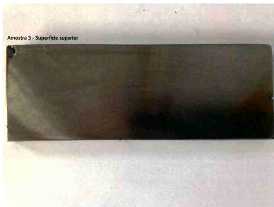
Figura 25: Superfície superior da amostra 3 após ensaio de imersão em cloreto férrico
