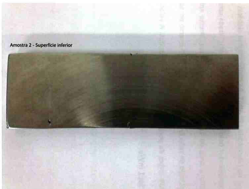
Figura 24: Superfície inferior da amostra 2 após ensaio de imersão em cloreto férrico
