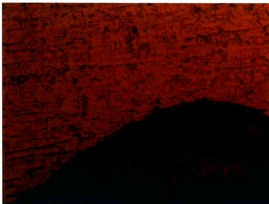
Figura 41: Ataque metalográfico com ácido oxálico. Interface entre cordão de solda e metal base. Aumento 50X
