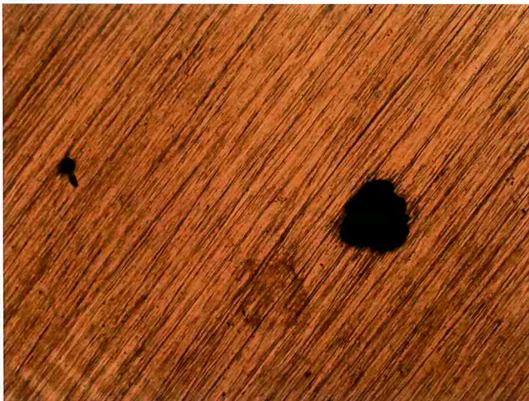
Figura 36: Pite formado na região do cordão de solda. Aumento 100X
