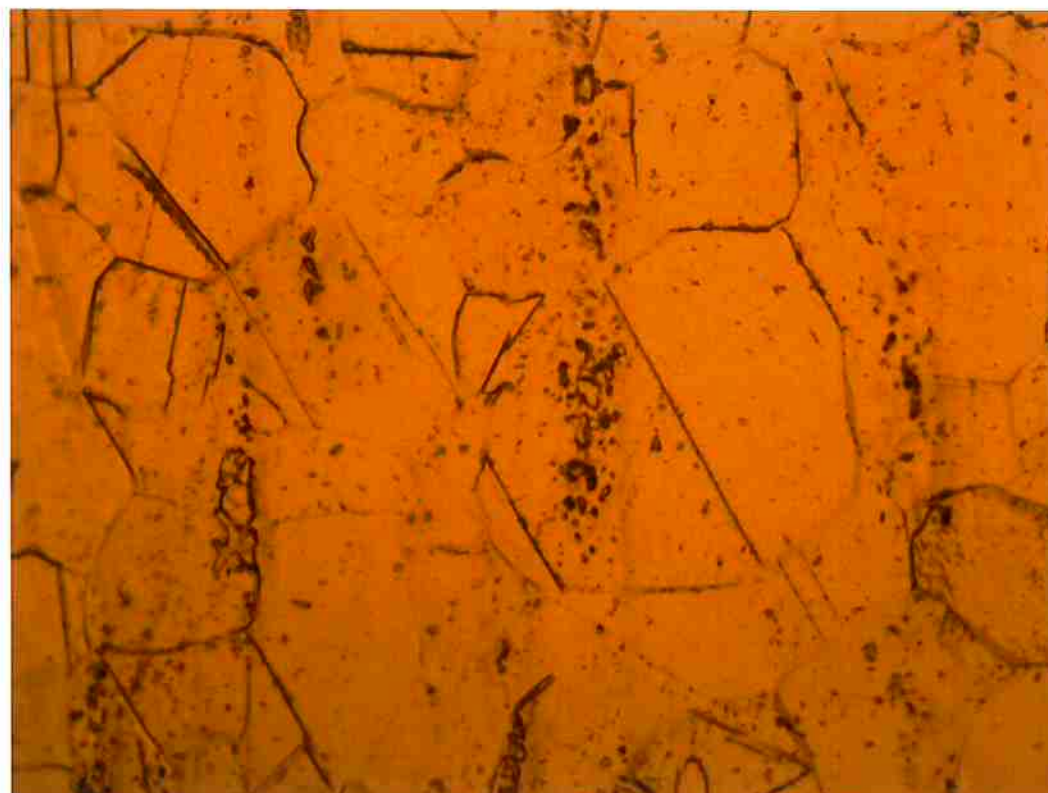
Figura 47: Ataque metalográfico com ácido oxálico. Região distante 5mm do cordão de solda. Aumento 500X
