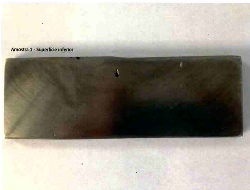
Figura 22: Superfície inferior da amostra 1 após ensaio de imersão em cloreto férrico
