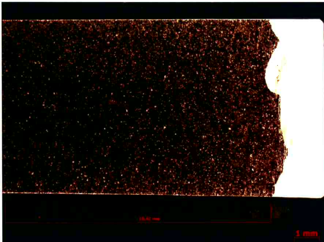
Figura 38: Corpo de prova após ataque metalográfico
