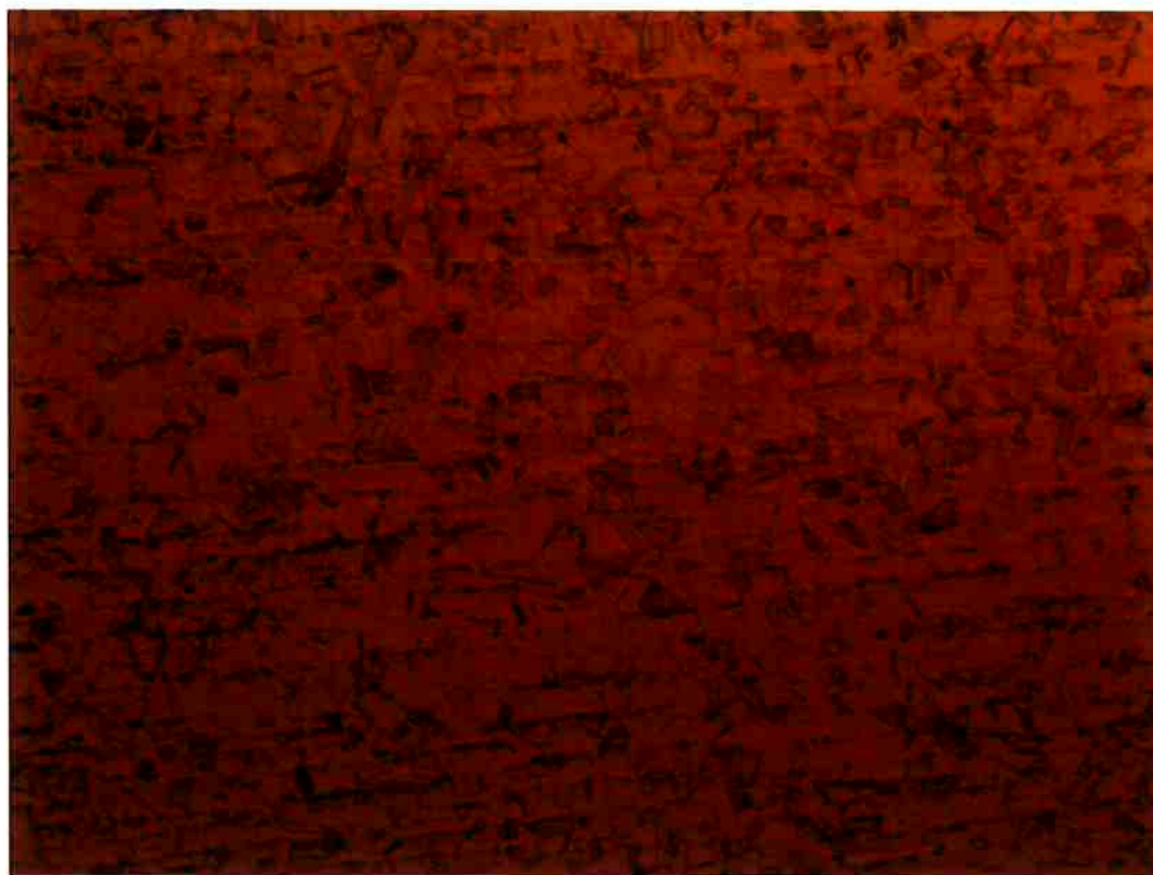
Figura 43: Ataque metalográfico com ácido oxálico. Região distante 5mm do cordão de solda. Aumento 50X
