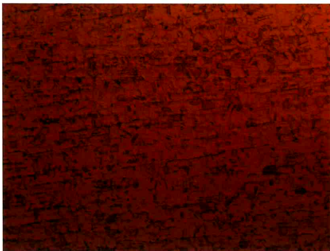
Figura 45: Ataque metalográfico com ácido oxálico. Região distante 12mm do cordão de solda. Aumento 50X
