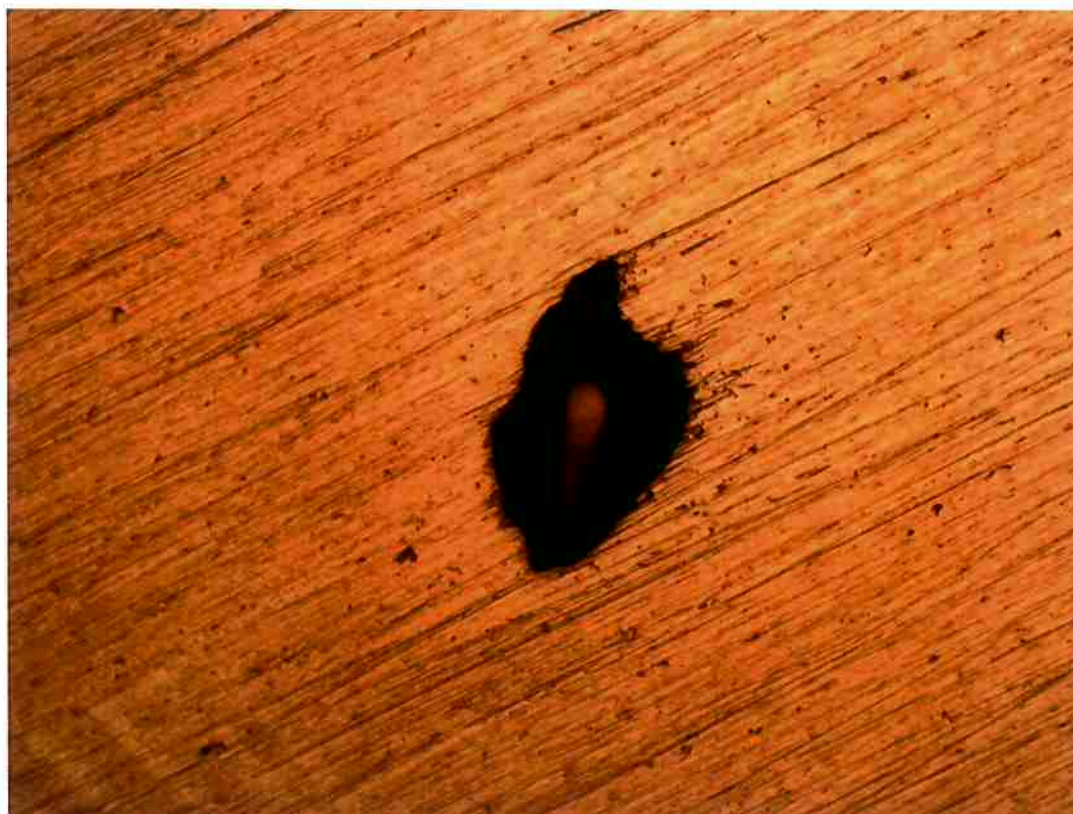
Figura 35: Pite formado na região do metal base. Aumento 200X
