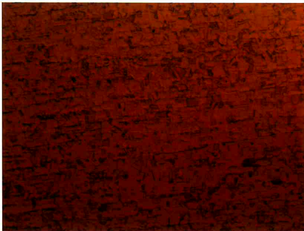
Figura 44: Ataque metalográfico com ácido oxálico. Região distante 9mm do cordão de solda. Aumento 50X
