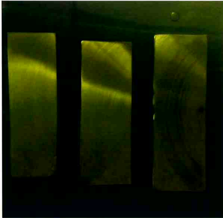
Figura 16: Amostras imersas em solução de cloreto férrico após 72 horas de ensaio
