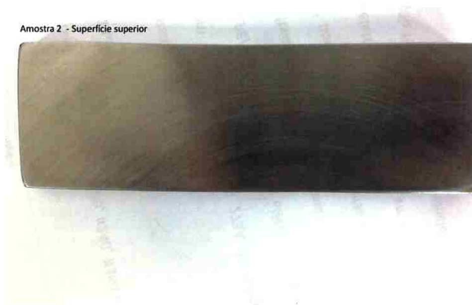
Figura 23: Superfície superior da amostra 2 após ensaio de imersão em cloreto férrico
