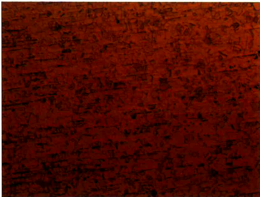
Figura 42: Ataque metalográfico com ácido oxálico. Região distante 1mm do cordão de solda. Aumento 50X
